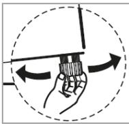
Prüfen Sie mit einer Wasserwaage, ob das Gerät waagegerecht steht. Wenn das Gerät nicht im Gleichgewicht steht, müssen die Standfüße justiert werden.
